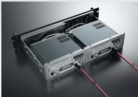
两路RF中继安装图（左边的是配件）
